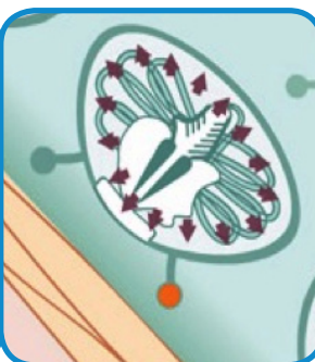
Dins de la càpsula es genera una alta pressió de 200 atm
