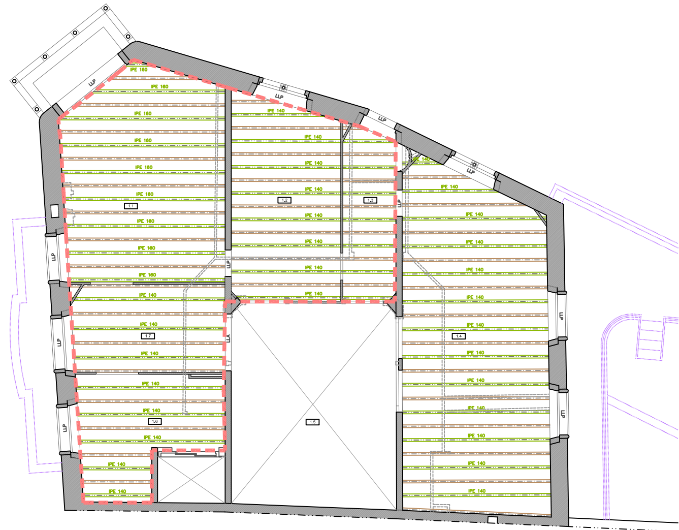
ESTRUCTURA SOSTRE PLANTA 1º
